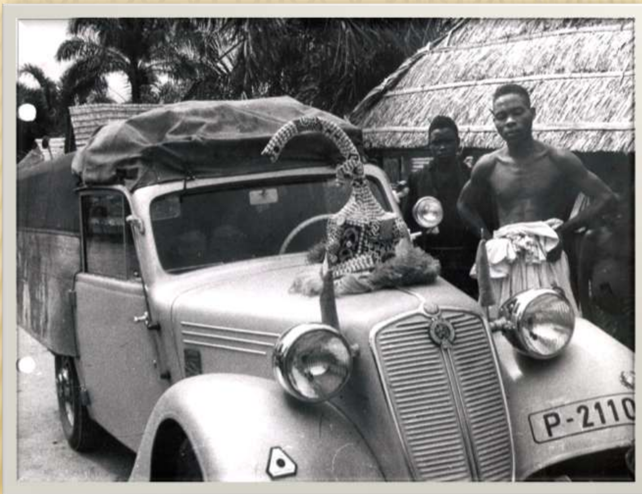
Vozidlo Tatra 57b s upravenou hliníkovou karoserií
